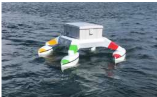
水素燃料電池を搭載した水上ドローン
