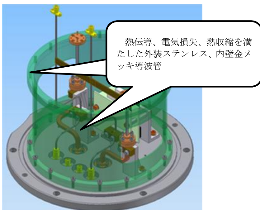
図 2 アルマバンド 10 受信機 300K 部の CAD モデル。 110K の低温部に接続される。
