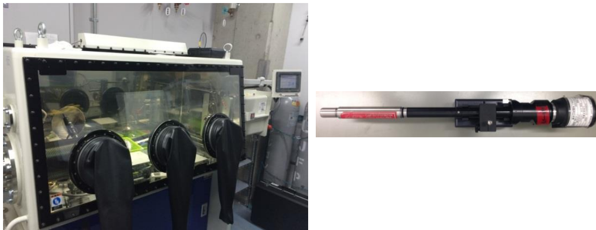
図2. 硫化物系電解質を空気にさらさずにTEM観察するための実験環境 左：グローブボックス 右：真空TEMホルダー
