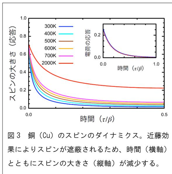
図3 銅 (Cu) のスピンのダイナミクス。近藤効果によりスピンの大きさが減少するとともにスピンの大きさが減少する。
