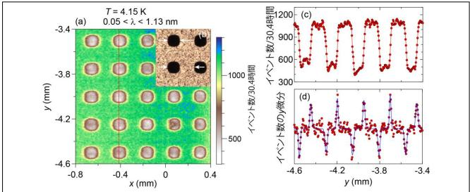
図2: (a) J-PARC で波長 0.05nm~1.13nm の中性子ビームを使って測定した 10B ドット列の中性子透過像を示 す。(b) 試験用の中性子吸収板(10B 粒子を穴に充填した厚み 50μm のステンレス板)の写真を(a) の右上に 尺度を揃えて重ねている。(c)中性子透過像に書かれた赤い線に沿っての中性子検出イベントのラインプロファ イルを示す。(d) ラインプロファイルの数値微分の曲線で、ピーク幅は、中性子透過像の各 10B ドットの境界の明 瞭さを示している。
