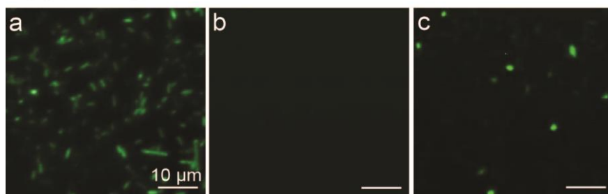
図3 ウェル内壁の顕微鏡像。ポリマー重合後(a)、溶菌処理後に得られた人工抗体(b)、人工抗体による標的細菌（抗原）の認識の様子(c)
