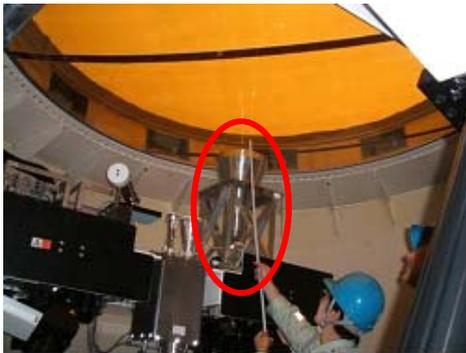
図7 6.7GHz 帯受信機の搭載試験
