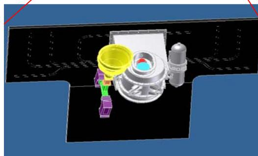
図10 ASTRO-G 衛星搭載 3 バンド受信機。望遠鏡カセグレン焦点位置に設置される。黄:8GHz 青:22GHz 赤:43GHz が各フィードホーンを示す
