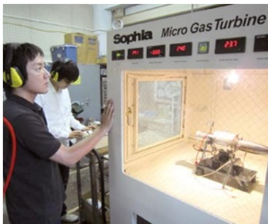
● ガスタービンエンジンの試験モデル
