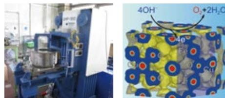
● 新材料開発に用いるWalker型超高压合成装置(左)。超高压条件下で合成された触媒材料における水の電気分解(陽極反応)の模式図(右)。
