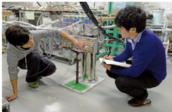
● 超伝導2次元検出器用GM極低温冷凍機を用いた実験
