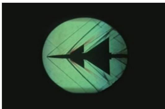
● 超音速機モデルの超音速風洞試験
