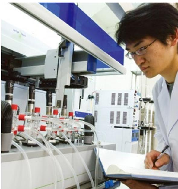
● 自動合成装置を用いた新しい有機化合物の合成
