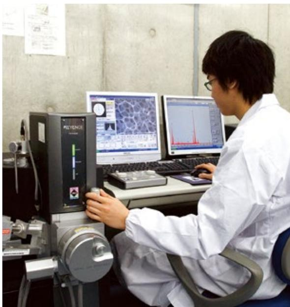
● 走査型電子顕微鏡による電極材料の表面観察および組成分析
