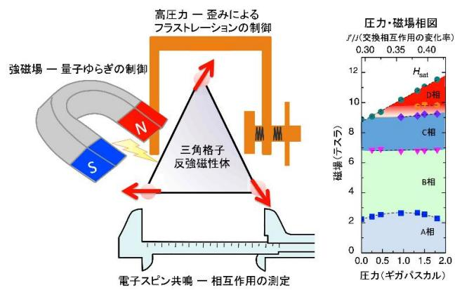
図 1. 三角格子に歪みを生じさせてフラストレーションを制御する高圧力と量子揺らぎを制御する強磁場を組み合わせて新たな量子相転移を発見し、電子スピノン共鳴によって歪みによる交換相互作用の変化を精密に決定した。右は実験から得られた温度・圧力相図と交換相互作用の変化率。
