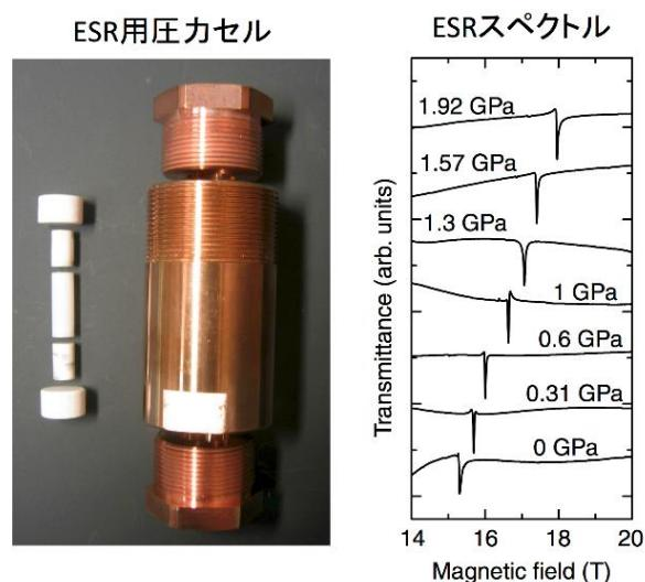
図 2. (左) 電子スピノン共鳴 (ESR) 用圧力セル。試料に圧力を加えるためのピストンが電磁波を透過するジルコニアで作製されている。(右) 330 GHz の電磁波を用いて観測された高圧下での ESR スペクトル。
