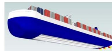
船の摩擦抵抗の大幅削減のための船底空気槽
