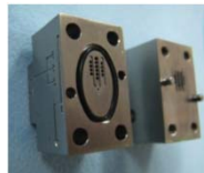
府立大学で開発された高効率混合を行えるマイクロミキサー(左)と光反応用のマイクロ回路(右)の例
